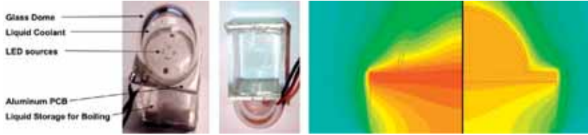
Şekil 22: Sıvı soğutmalı LED ışık motoru çalışması sonuçları (12)
