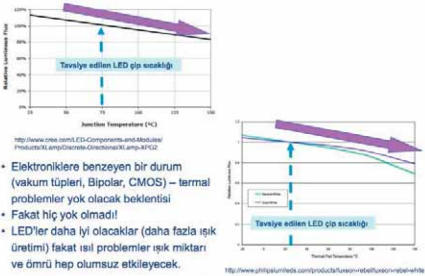
Şekil 12: 2014 yılında lider LED çip firmalarından alınan verilere göre sıcaklığın ışık üzerine etkisi (12)
