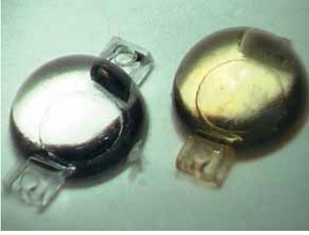
Şekil 18: Zamanla performansı düşen bir LED lensinin renk değişimi ve ışık kayıpları (4)
