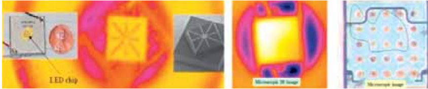
Şekil 13: Paketleme hatasına örnek (11)
