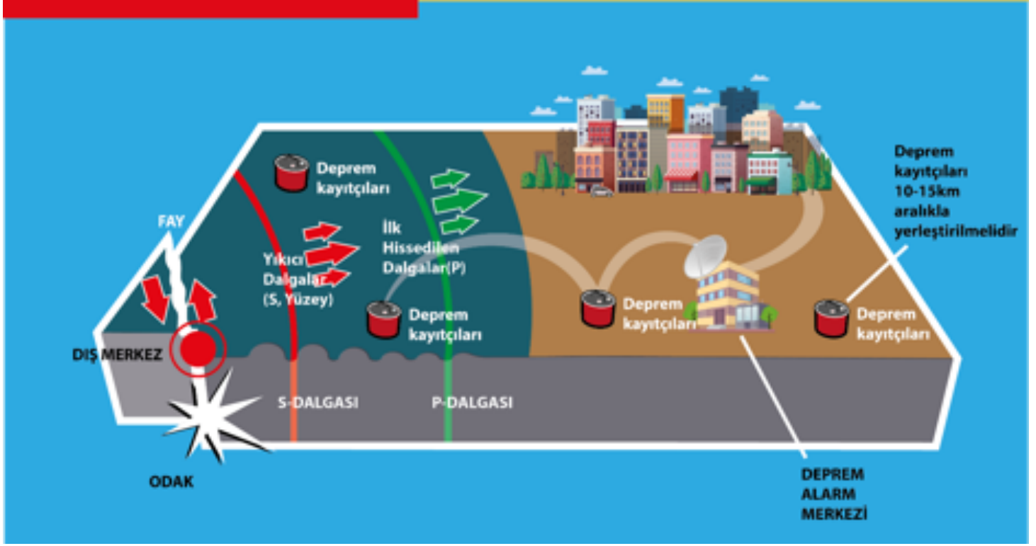
Şekil 1. Deprem erken uyarı sisteminin şematik gösterimi. Deprem iç merkezi odak olarak gösterilmiştir. En hızlı ilerleyen dalgalar ilk dalga (P) olarak, daha düşük hızla ilerleyen ikincil dalgalar (S) ve üçüncül olarak en yavaş dalgalar yüzey dalgası olarak gösterilmiştir (Barış vd., 2022 ve Barış vd., 2023'ten den alınmıştır).
